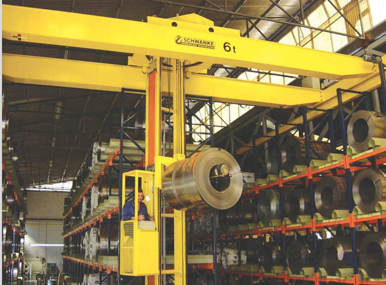
As pontes rolantes empilhadeiras são equipamentos desenvolvidos para transportar cargas paletizadas e materiais cilíndricos (bobinas de aço, rolos de tecido e papel, etc.) com utilização racional e máxima do espaço disponível.
